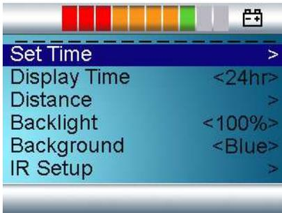
Avec le menu options vous aurez la possibilité de modifier l'horloge, la luminosité, l'éclairage de fond, la couleur et le compteur de kilomètres. Afin d'entrer dans le menu de réglage appuyez simultanément sur les touches d'accélération et de décélération.
