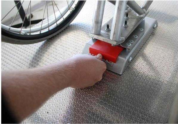
1. Fahren Sie den Rollstuhl in der Docking-Station so weit nach vorn wie möglich, um den Druck auf den Sperrstift aufzuheben.
