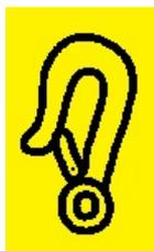
Symbol für den geprüften Befestigungspunkt für Spanngurte.
