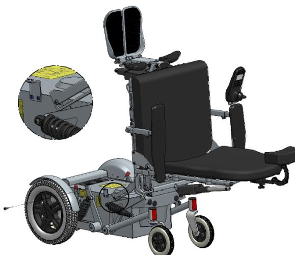
Figure 4 Fauteuil ouvert pour le compartiment des batteries
