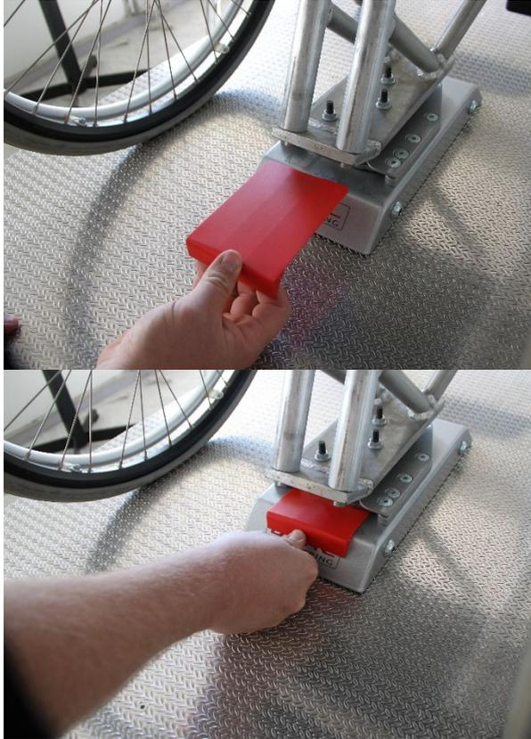
1. Fahren Sie den Rollstuhl in der Docking-Station so weit nach vorn wie möglich, um den Druck auf den Sperrstift aufzuheben.
