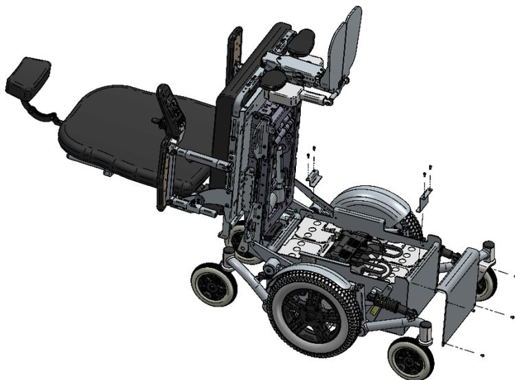
Abbildung 6 Batteriefrontplatte
