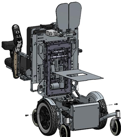
Abbildung 5 Stuhl zwecks Zugang zum Batteriefach öffnen
