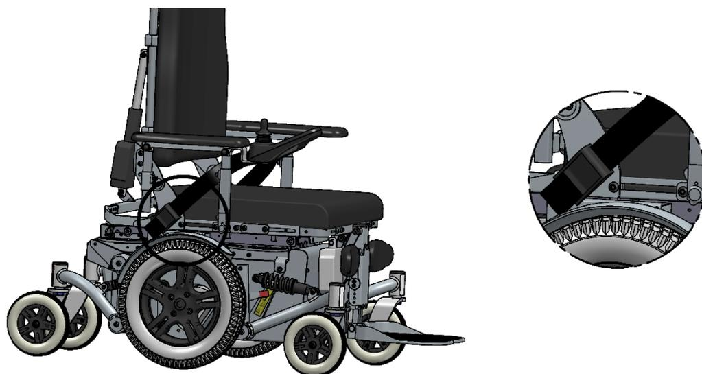
Abbildung 8 Montage des Beckengurtes
