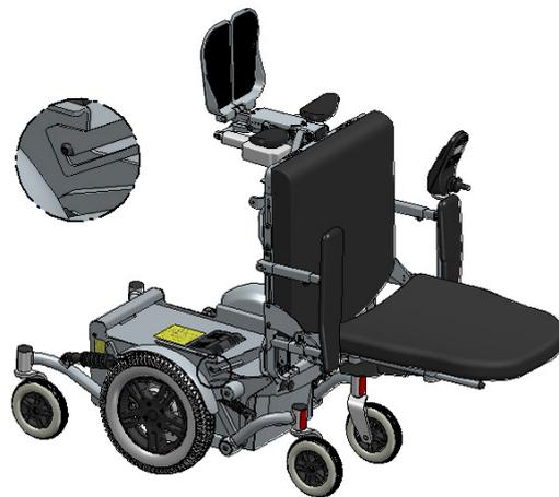
Abbildung 4 Stuhl zwecks Zugang zum Batteriefach öffnen
