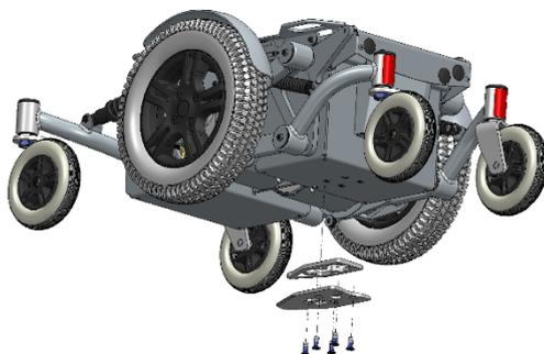
**!** Die Dahl Torx-Spezialbolzen gibt es in nur einer Länge, die oft zu lang ist. Entfernen Sie überschüssiges Gewinde an allen Bolzen. Es ist sehr wichtig, die Länge der Bolzen zu prüfen. Falls die Bolzen zu kurz sind, greifen sie nicht voll ins Gewinde und haben damit nicht genügend Festigkeit, um der Belastung zu widerstehen, der sie ausgesetzt werden. Falls die Bolzen zu lang sind, können
