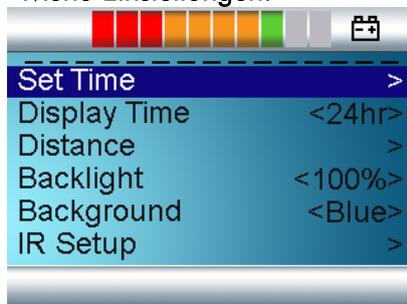
Im Menü Einstellungen können die Uhr, die Helligkeit, die Hintergrundbeleuchtung, die Farbe und der Kilometerzähler eingestellt werden.
