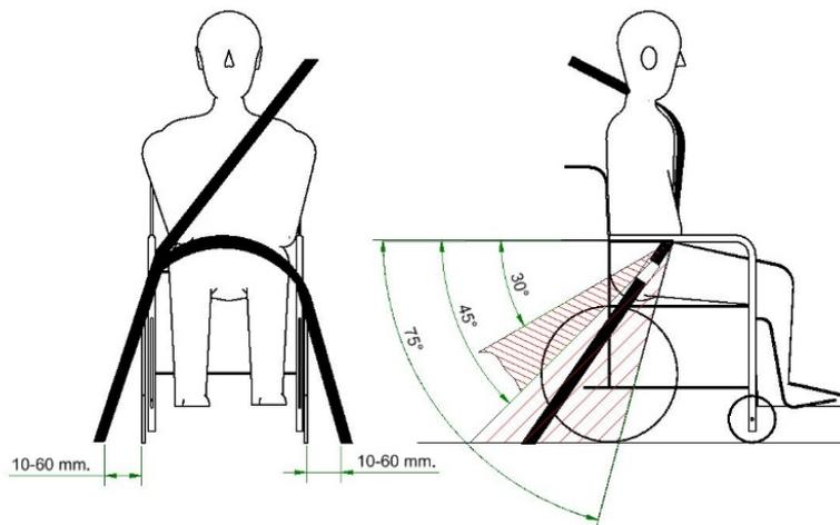
Bevorzugte (preferred) und alternative (optional) Winkel für den Beckengurt bei Verwendung eines Dahl Docking-Systems
