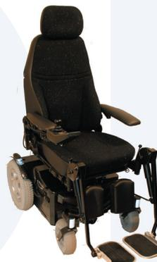
Pour ROLTEC VISION nous avons développé un système de levage/basculage unique qui peut varier la hauteur de la position assise de 47 à 78 cm. La fonction de basculage peut basculer de 24 degrés vers l'arrière et de 7 degrés vers l'avant. Dans le basculage est incorporé une fonction mémoire qui assure que l'on peut toujours revenir à la position horizontale. Le dos électrique en combinaison avec le basculage électrique donne des possibilités optimales de variation de la position assise.
